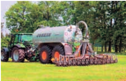
Sistema de inyección de estiércol.
